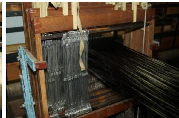
Изготовлены преформы образцов по технологии 3D-ткачества
